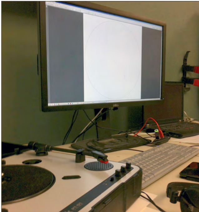
Auf dem Bildschirm ist eine Druckdatei mit der Schneidgrafik angezeigt. Diese Linien (Außenform und Mittelloch) werden vom Lasercutter geschnitten, bevor die Plattenrillen mit dem Klang gelasert wurden. (Foto: Daniel Paschen 2014)
